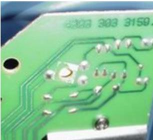
Op deze foto zie je de een detail van het gaatje, je kunt dan ook de rest zien van het vierkante celstof lapje dat over het gaatje geplakt zat. In principe kan je met je schroevendraaier door dat lapje heen steken, maar kunt het ook met een scherp mesje of schroevendraaiertje wegschrappen
