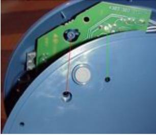
Als je de bodem losschroeft dan kun je zien waar het gaatje voor de schroevendraaier uitkomt op de printplaat. Na het volledig losschroeven de bodemplaat (pas wel op: de pomp blijft op de bodemplaat vastzitten) krijg je goed zicht op de printplaat. (klik steeds op de foto voor een vergroting)
