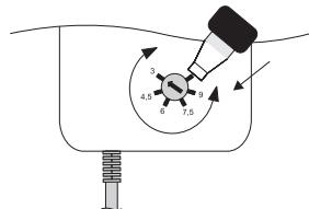
**ATTENTION !** Réglez uniquement la tension de sortie lorsque le bloc d'alimentation est hors-tension ! Respectez la tension de fonctionnement des consommateurs ! Veillez également à ce que le sélecteur soit correctement enclenché dans la gamme de tension respective !
