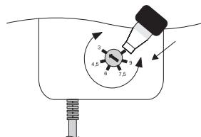
**ACHTUNG!** Nur im Stromlosen Zustand die Ausgangsspannung umschalten! Betriebsspannung der Verbraucher beachten! Achten Sie ebenso auf eine aubere Einrastung des Umschalters im jeweiligen Spannungsbereich!
