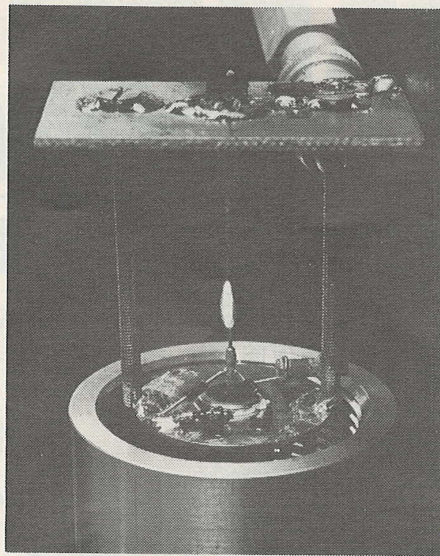
Afb. 13 Test op de bestandheid tegen elektrische ontladingen, M.b.v. een autobobine worden vonken met een lengte van 7 mm toegevoerd aan de ingang van de versterker.
